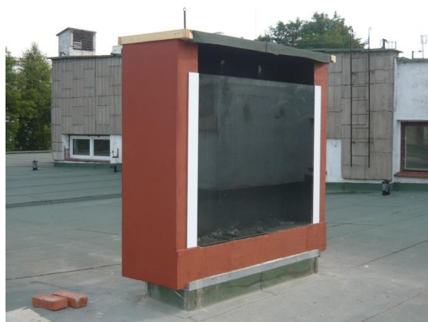
Fot. 2. Widok badanego kamina słonecznego Phot. 2. View tested the solar chimney
