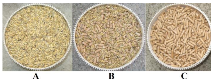
Rys. 2. Rodzaje spalanej paliwa: A – ziarno owsa, B – mieszanka pelletu i owsa, C – pellet drewniany.
