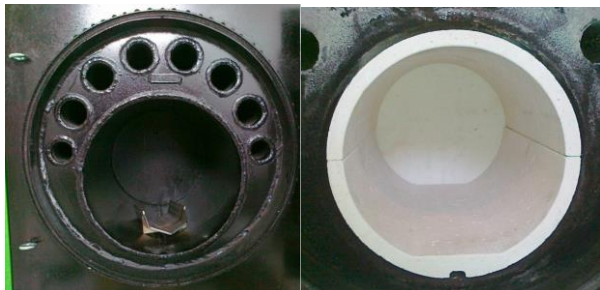
Rys. 6. Komora spalania w podstawowym standardzie (widok po lewej) i z wkładem ceramicznym (widok po prawej)
